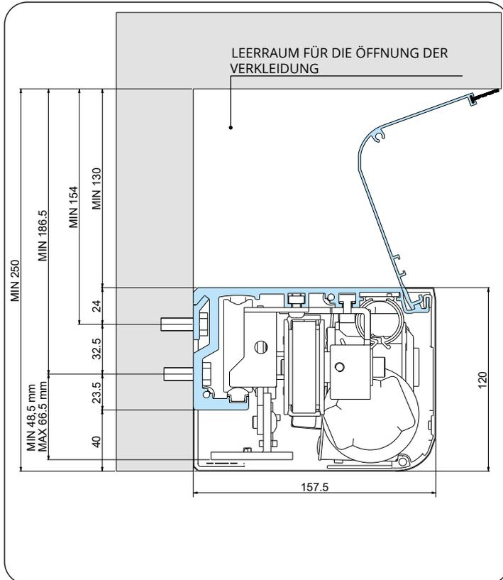
Mindestabmessungen zum Öffnen des Gehäuses mit Gelenksatz
