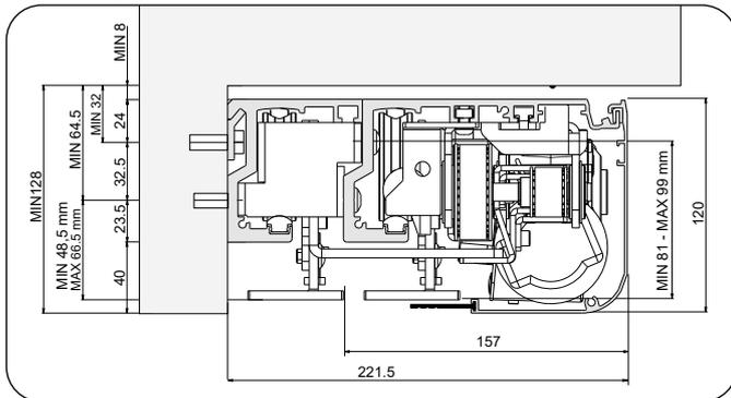
Mindestabmessungen zum Öffnen des Gehäuses nach oben
