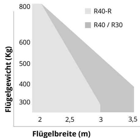
\* sie beziehen sich auf Rahmenflügel. Wenn die Flügel vollständig geschlossen sind und das Tor installiert wird, in Orten auf Wind ausgesetzt, müssen die angegebenen Längen für jedes Modell um 30% REDUZIERT werden.
